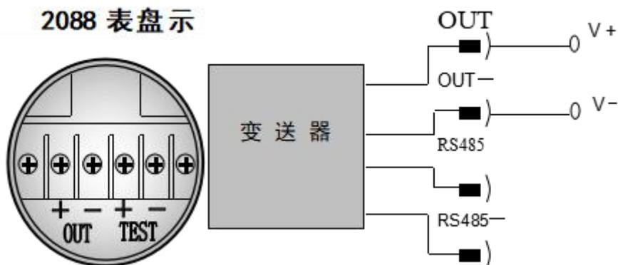
信号线可采用双绞线。在电磁干扰较严重的场合，建议使用屏蔽导线，并妥善接地。信号线不要与其它电源线一起穿金属管或放在同一线槽中，也不要再在强电设备附近通过。
